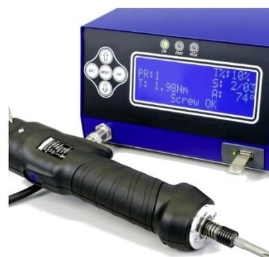
Con un range di coppia da 0,02Nm fino a 70Nm, sono lo strumento ideale per un assemblaggio di qualità a costi competitivi. Il motore a spazzole offre una elevata affidabilità e una ridotta manutenzione mentre la versione brushless elimina la sostituzione delle spazzole.
